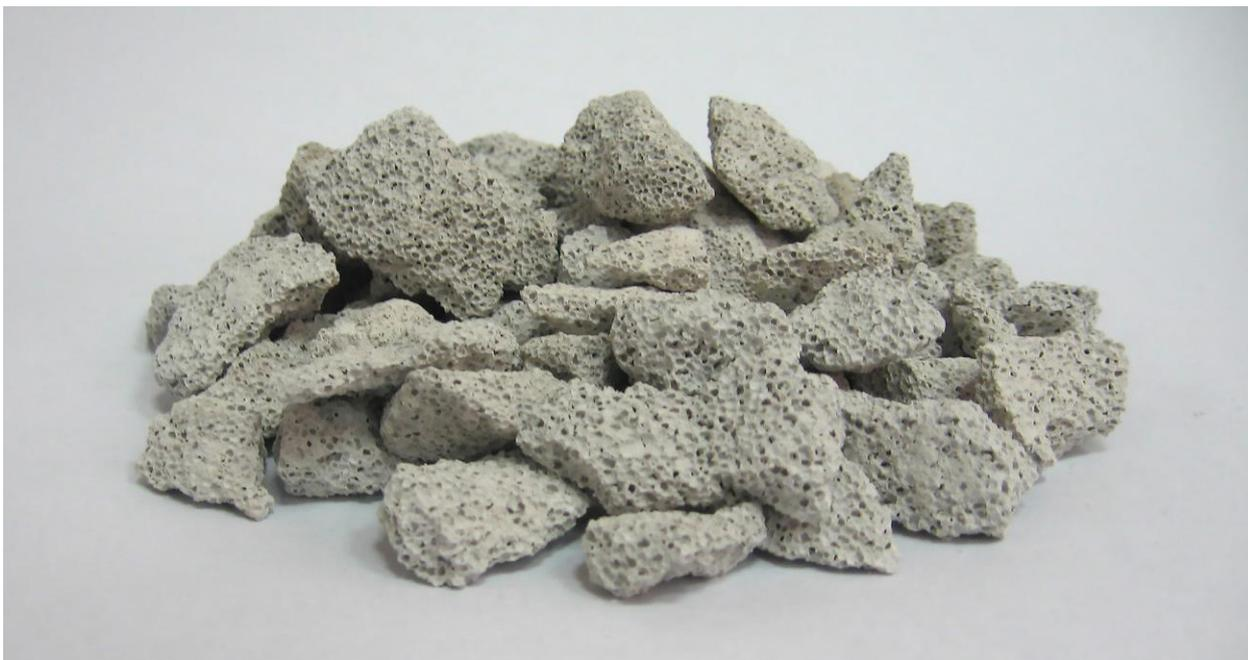
Для утепления плоских кровель, и чердачных перекрытий удобнее всего применять насыпной утеплитель из автоклавного газобетона, как долговечный и эффективный утеплитель.
